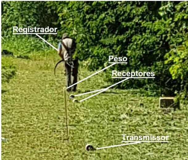
Figura 3 – OhmMapper e seus componentes sendo utilizado para aquisição dos dados
